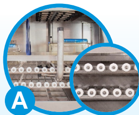
Visão Interna da Esteira de Lavagem
