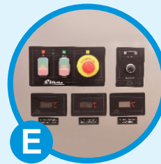
Painel com Visores de Temperatura Separados por Etapas de Lavagem
